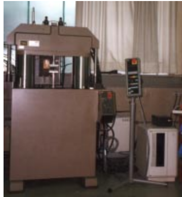
Abb. 2: Foto der Servohydraulikmaschine mit eingespanntem Prüfkörper
