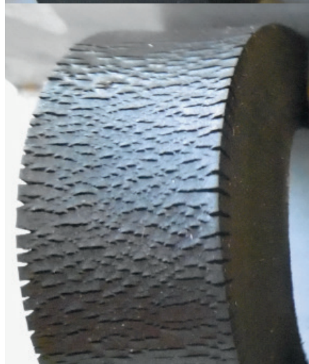
Material ohne und mit Rissbildung nach Ozonexposition.
