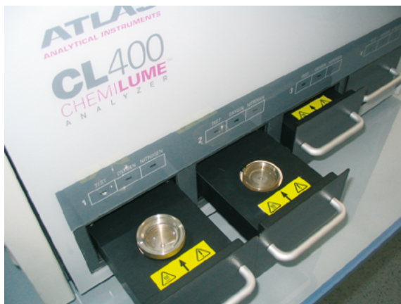
Chemilumineszenzapparatur zur Bestimmung von OIT-Werten (Oxygene Induction Time)
