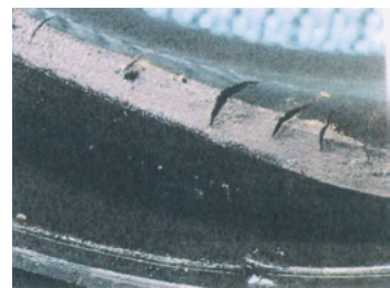
Radialwellendichtring mit Rissbildung
