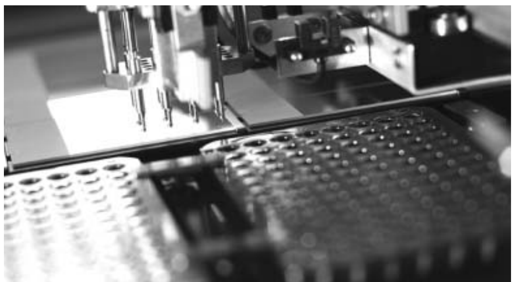
Herstellung von DNA-Chips mit dem Affymetrix System
