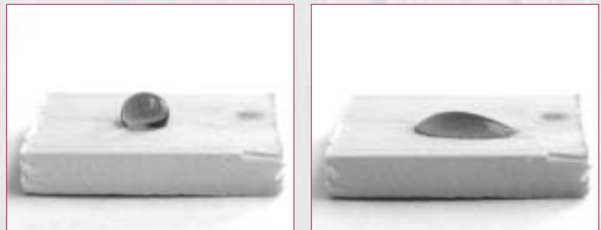
Ein Wassertropfen auf unbehandeltem (links) und auf plasmabehandeltem Fichtenholz
