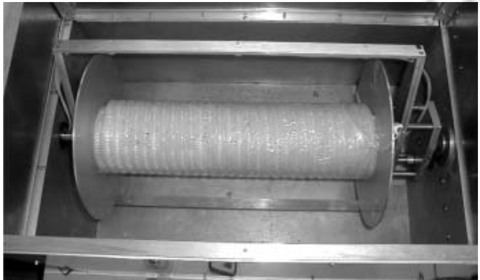
Die Slow rotating CCC ist mit speziellen spiralförmigen Trennschläuchen ausgerüstet.
