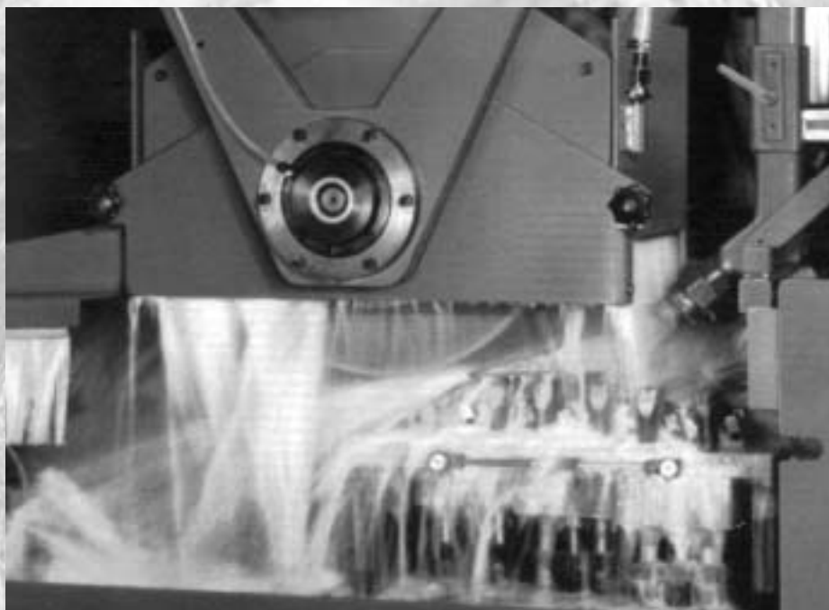
Kühlschmierstoff im Einsatz an einer Schleifmaschine
