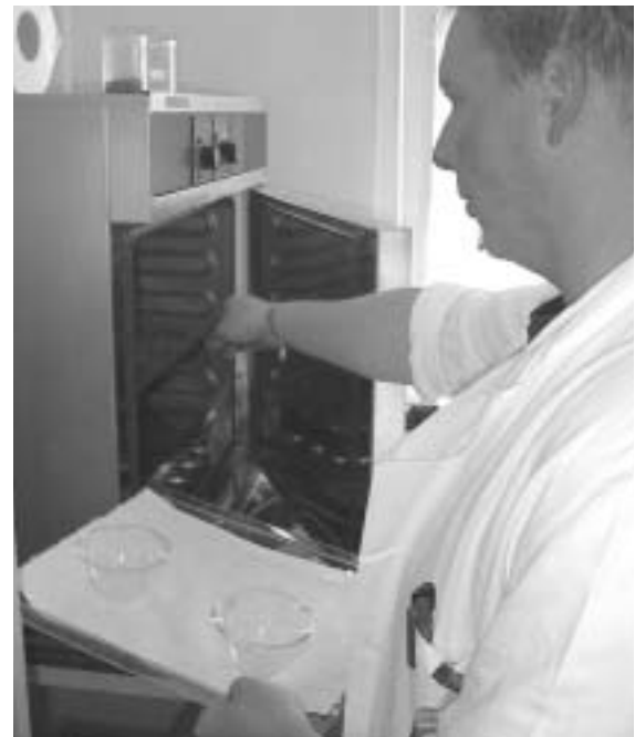
Nach dem Reinigungsprozess wird die Spülösung mit den entfernten Partikeln in Abdampfschalen eingeeengt und dann ausgewogen.
