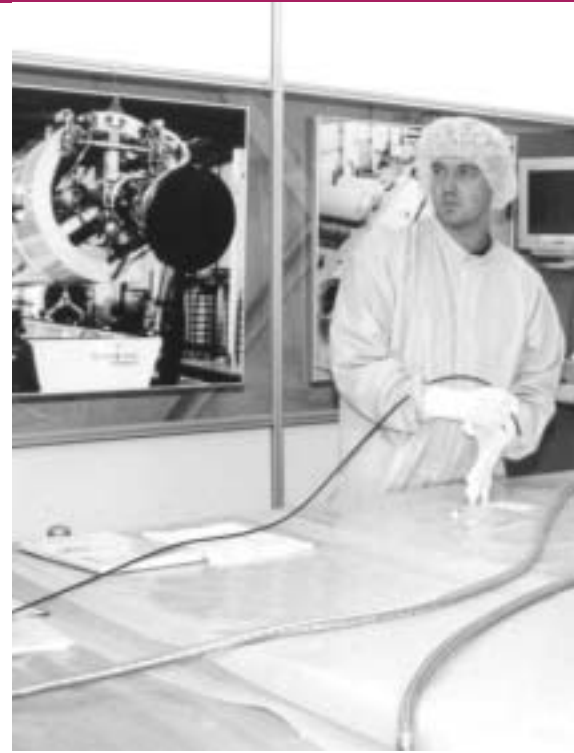
Anlage zur Spülung der Rohrleitungssysteme unter Re
